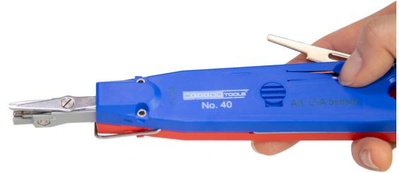
Mit dem Sensor No. 40 können Adern mit einem Leitungsdurchmesser von 0,35 - 0,9 mm und einem Aderdurchmesser von 0,7 - 2,6 mm auf LSA-Leisten oder -Blöcke aufgeschaltet werden. Durch einen leichten Druck auf das Werkzeug werden Adern in nur einem Arbeitsgang kontaktiert und abgeschnitten. Ein manuelles Abisolieren oder Schrauben ist hierbei nicht erforderlich.
